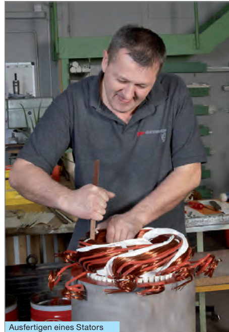
Ausfertigen eines Stators
